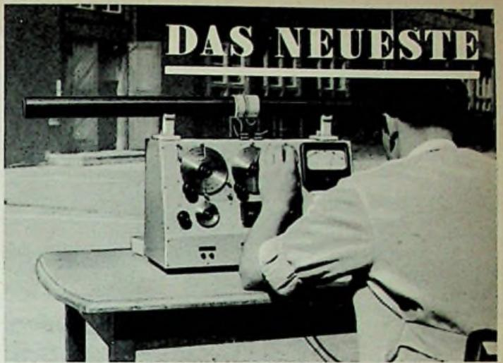
Sonderausführung einer Ferrit-Peilstabantenne. Länge: 1 m, Durchmesser: 50 mm außen, 24 mm innen (Philips)
